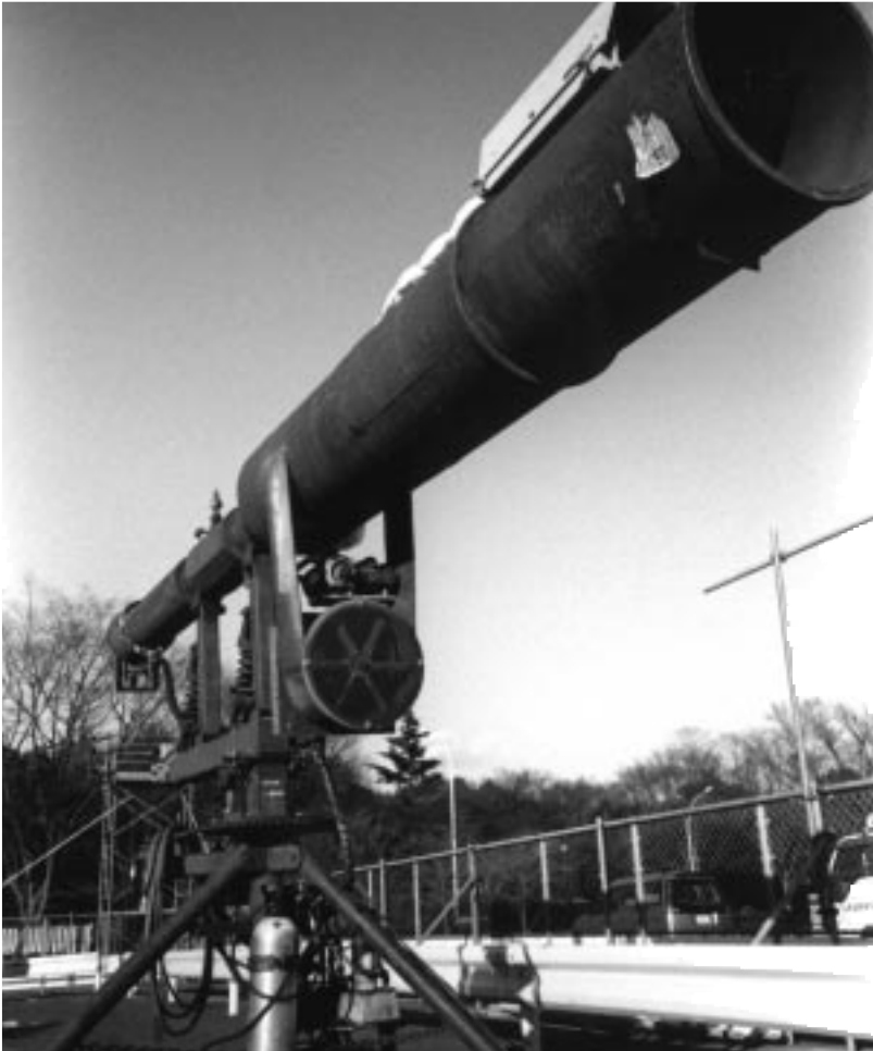
ショックウェーブ・キャノン プロパンガスと酸素を充填して爆発させる巨大な空砲。爆発により圧縮空気の衝撃波を発生する。
