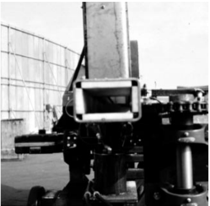
上—ピッチング・マシンの駆動部アップ。このタイヤの間から棒を打ち出す。
