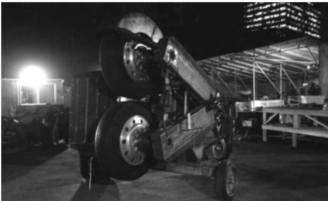
調整中のピッチング・マシン。自動車エンジンにより2mほどの木の棒を高速で打ち出すことができる。ネットワーク経由でもコントロール可能。
