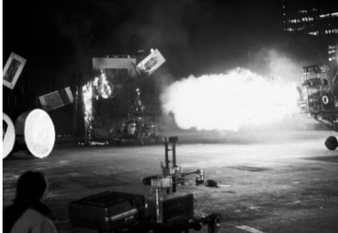
上——手前:トラック・ロボット ICCよりネットワーク経由でコントロールされた。後方:ターボジェットにより燃やされる岩形プロップ(大道具)。
